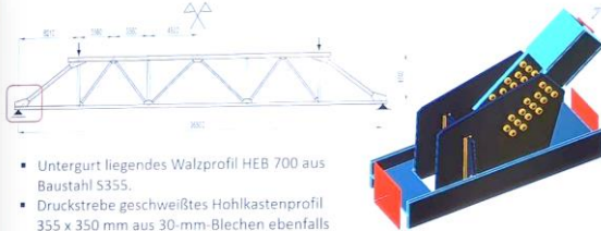
Stabilitätsproblem eines Fachwerkknotens verursacht Schadensfall
