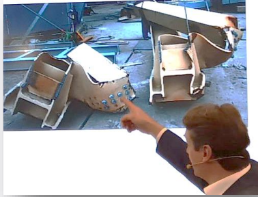
Stabilitätsproblem eines Fachwerkknotens verursacht Schadensfall
